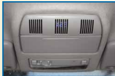
Kleines, aber wichtiges Detail: die Spannungsanzeige
