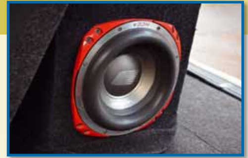
Geringer Platzverbrauch und „Wow-Effekt“: Der Orion HCCA 10.2 spielt im selbst abgestimmten Bassreflexgehäuse bis unter 20 Hz
