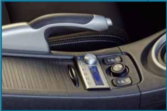
Am Einbauplatz des Aschenbechers wurde das Bedienteil des Bit One verbaut
