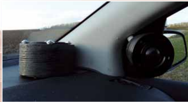
Beim Mitteltoner wurde von direkter auf indirekte Ausrichtung über Scheibenreflexion umgestellt
