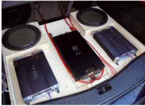
Unter dem doppelten Boden verbergen sich Verstärker und Aliante-Woofers
