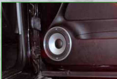
In der Tür sitzt das Andrian-Audio-Tiefmitteltöner-Chassis auf einem massiven Stahlring
