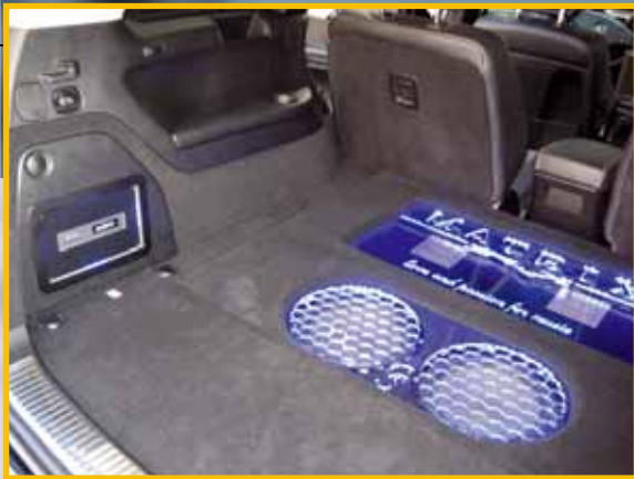
Der Bit One wird von einem stabilen Holzrahmen gehalten und wanderte ins linke Seitenteil
