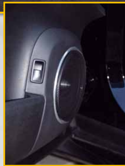
Die 6.1PP wurden in einlaminieren Metallringen auf die Türverkleidung aufgesetzt
