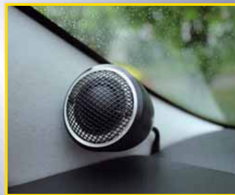
Die RS-Audio-Hochtöner an den A-Säulen-Verkleidungen erhielten hochwertige handgedrechselte Holzkapseln
