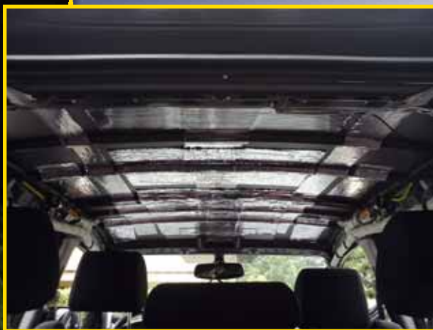
Wie für Sound-Quality-Anlagen typisch ist der Corolla vollständig gedämmt
