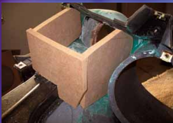
Hier sieht man das von hinten im Armaturen Brett angebaute Volumen der Mitteltöner
