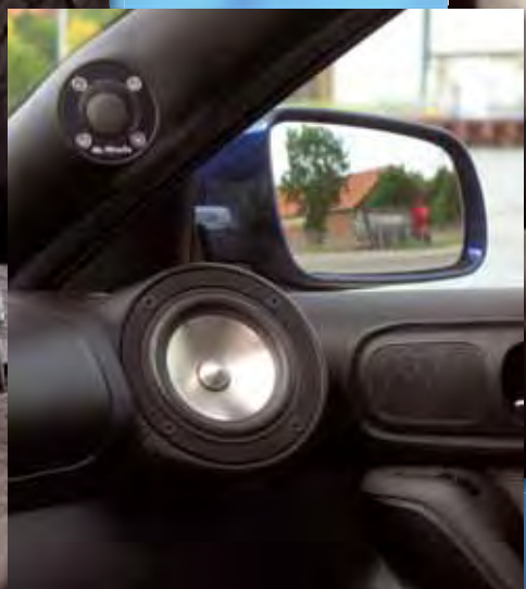
Für den Mitteltöner hat sich der ausgerichtete Einbau im Armaturenbrett als günstig erwiesen, der auf Neodym umgebaute Hochtöner passt jetzt in die A-Säule
