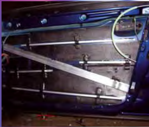
Gut kann man die angeklebten Aluprofile erkennen, hier ist die erste von 5 Lagen Bitumen drauf
