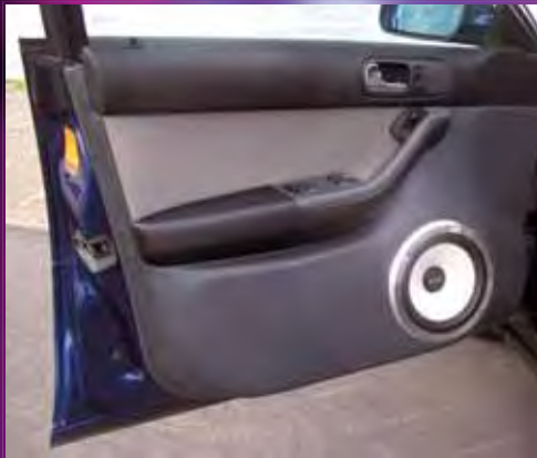
Das Doorboard mit geschlossenem Gehäuse ist mit GFK und Formvlies mit der Türverkleidung verbunden
